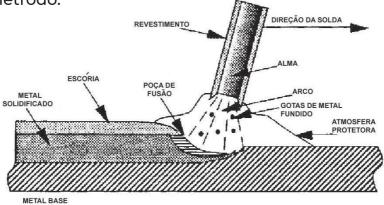
O metal de base no percurso do arco é aquecido, formando uma poça de metal fundido. O eletrodo é também fundido e assim transferido à poça de fusão a elevada temperatura. Nessas condições há expansão dos gases contidos no eletrodo, bem como os gases produzidos pela elevada temperatura dos componentes do revestimento.
