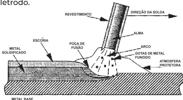
O metal de base no percurso do arco é aquecido, formando uma poça de metal fundido. O eletrodo é também fundido e assim transferido à poça de fusão a elevada temperatura. Nessas condições há expansão dos gases contidos no eletrodo, bem como os gases produzidos pela elevada temperatura dos componentes do revestimento.
