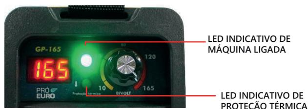
Neste momento, não desligue o equipamento, pois a ventoinha precisa ficar funcionando para acelerar o processo de resfriamento. Aguarde até que o indicador apague. O protetor térmico irá reiniciar automaticamente e a luz indicadora do painel desligará. Após isso volte a utilizar o equipamento.
