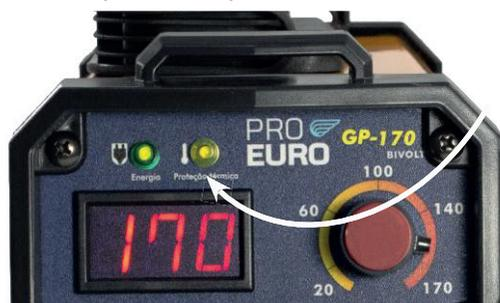
Neste momento, não desligue o equipamento, pois a ventoinha precisa ficar funcionando para acelerar o processo de resfriamento. Aguarde até que o indicador apague. O protetor térmico irá reiniciar automaticamente e a luz indicadora do painel desligará. Após isso volte a utilizar o equipamento.
